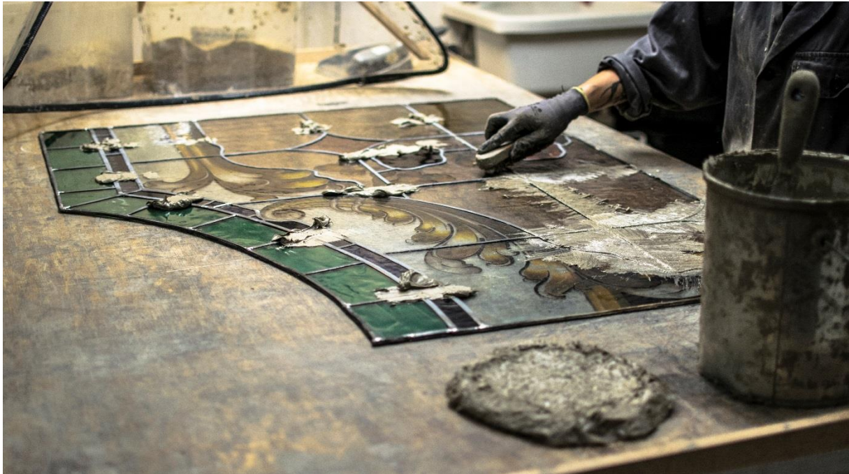
Einschleppen von Verstreichkitt in Bleiruten
