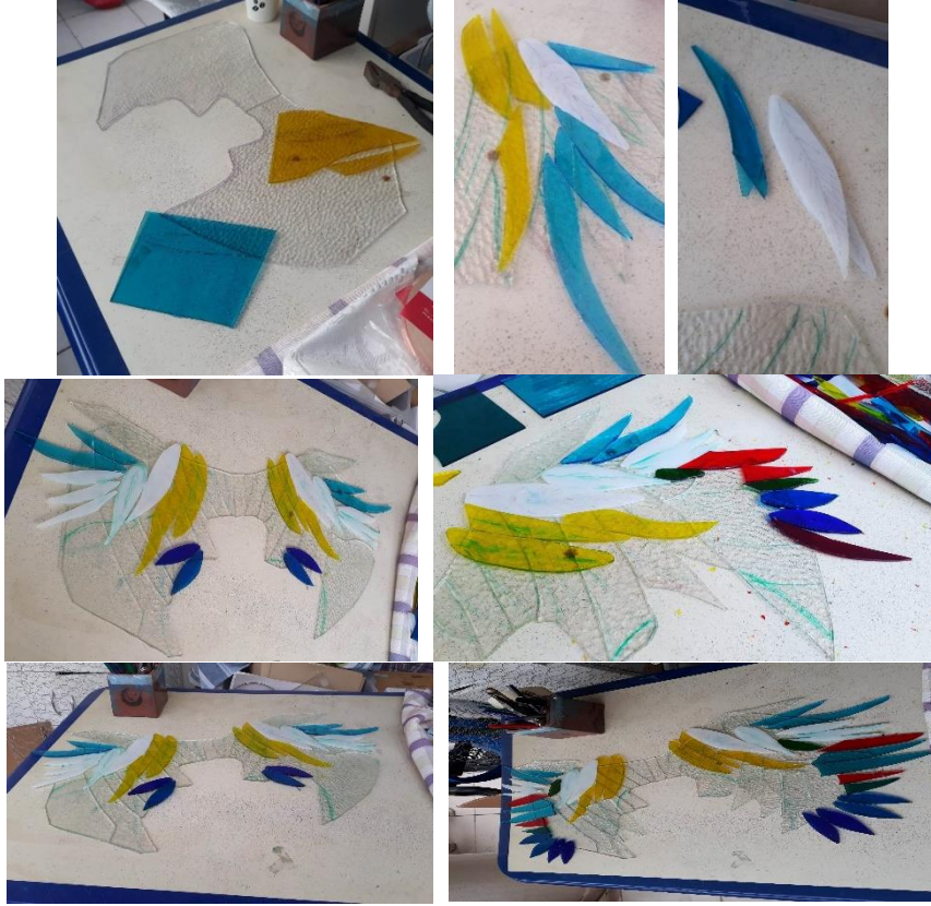
Görsel 28. Victoria mitolojik karakteri için hazırlanmış olan melek kanatları camların renk seçimi yapılır. Vitray camların kesimlerine cam elması ile başlanır. Kullanılan Vitray camları 3mm vitray camlarıdır.
