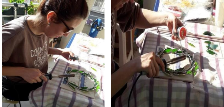
Görsel 27. Vitray cam galvaniz tel ile lehim suyu sürülerek parçalar lehim tel, havaya ile eritilip birleştirilir.
